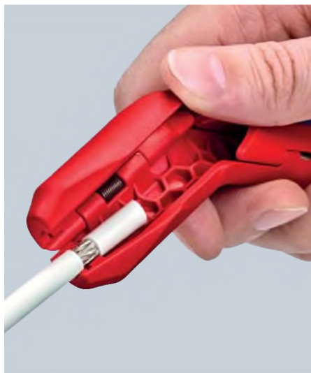
Удаление оболочки с коаксиального кабеля
