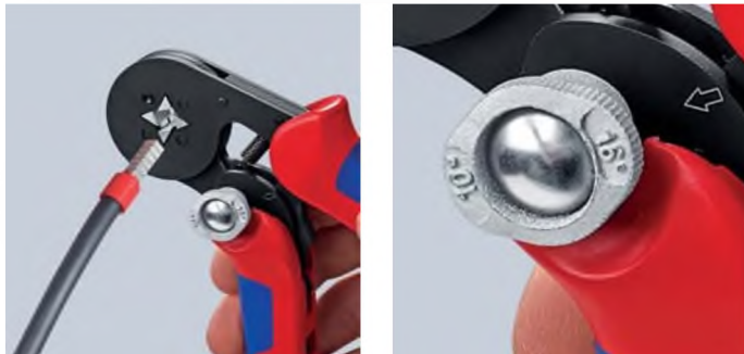
Переход параметра обжима с 10 мм 2 на 16 мм 2 происходит путем простого переключения
