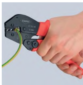
Третий этап: при необходимости увеличенного усилия опрессовки, например, для изолированных контактов 6,00 мм 2 ; при наличии удлиненных ручек возможна работа обеими руками
