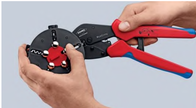
Смена профилей опрессовки: разблокируйте положение магазина, выдвиньте профиль опрессовки из клещей
