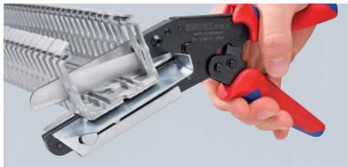
95 02 21: Длина режущей кромки 110 мм, для разделки широких кабельных каналов, также подходит для пластмассы толщиной до 4 мм
