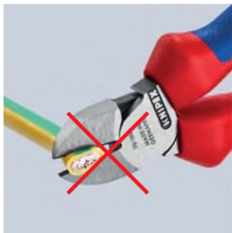
Рез кабеля диагональными кусачками: большое усилие, неаккуратный рез, сильная деформация и смятие кабеля
