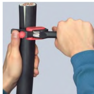
Вращение инструмента для разреза по окружности
