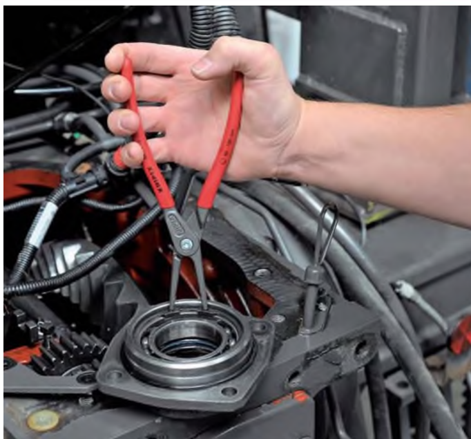
Прочные запрессованные концы из пружинной стали с высокой степенью сжатия
