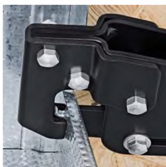
Установка инструмента на оба соединяемых профиля
