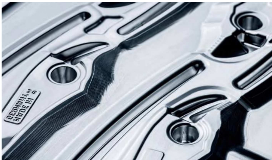
Кузнечный штамп для производства боковых кусачек особой мощности с накованной осью шарнира.
