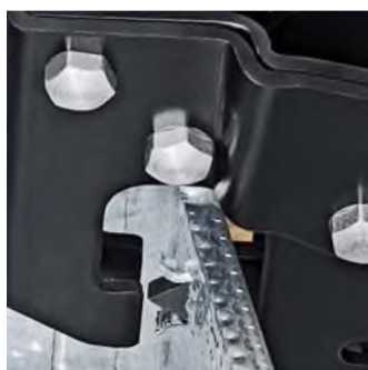
Пуансон инструмента продавливается через профили
