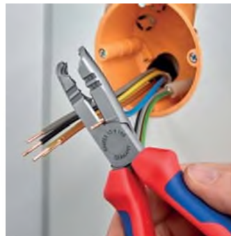
Укорачивание отдельных проводов
