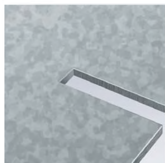
Вырубание краев и ломка стружки за один рабочий ход
