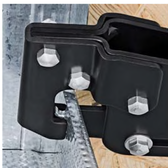
Установка инструмента на оба соединяемых профиля
