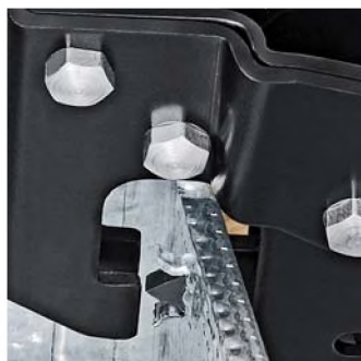
Пуансон инструмента продавливается через профили
