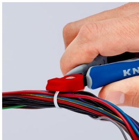
Удалите замок кабельной стяжки с помощью Боковых кусачек для электроники...
