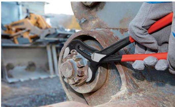
KNIPEX Alligator® XL обеспечивает эффективность и удобство работы сантехническими клещами при весе меньше на 50% и большей захватной способности (3 1/2"), чем у трубных клещей того же размера. В самом распространенном формате 400 мм KNIPEX Alligator® XL легко разместится в любой сумке для инструментов.
