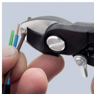
95 41 165: с функцией удаления изоляции
