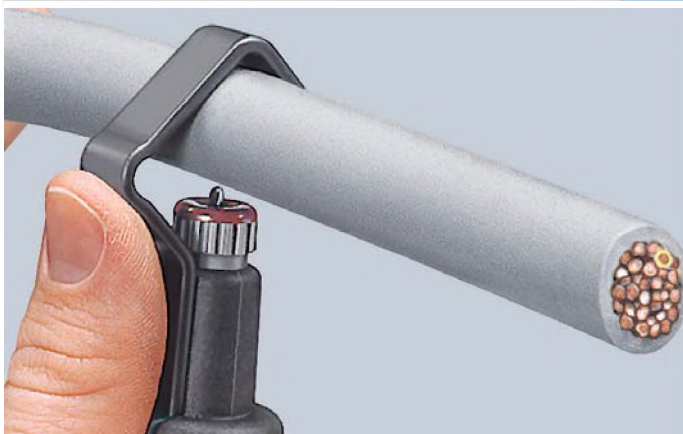
Установка инструмента для разреза по окружности
