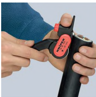
Установка инструмента для продольного реза
