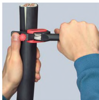
Вращение инструмента для разреза по окружности
