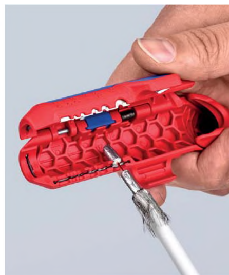
Удаление изоляции с дата-кабеля
