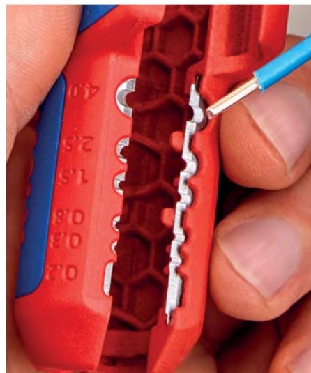
Удаление изоляции с отдельных проводов
