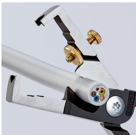
Закалённое токами высокой частоты лезвие с прецизионной заточкой для точного резамедного или алюминиевого кабеля диаметром до 15 мм (5 x 2,5 мм 2 )
