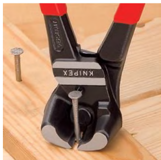
Обрезка винтов, гвоздей и т.д. почти заподлицо
